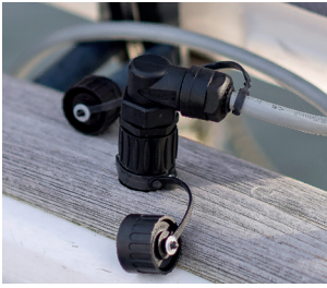
[bild 4 ] Genomföringskontakterna installerade på båten
