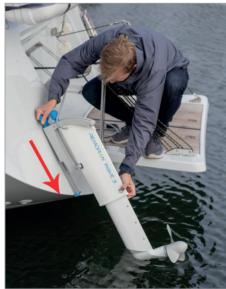
[bild 27] Placera den utvändiga enhetens stomme i den övre änden av skenan och skjut ned den längs skenan.
