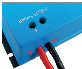
[bild 17] Anslut laddningsledarna omsorgsfullt till de rätta hålen så att + och - ledarna dras till de erforderliga positionerna.
