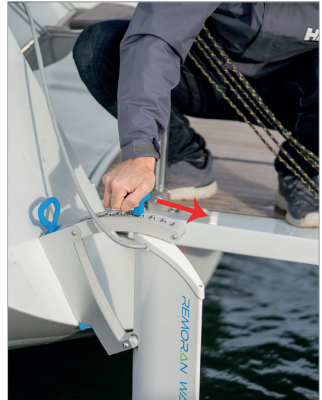
[Kuva 29] Sääda ulkoyksikön kulma suoraan kulmaan veden pintaan nähden
