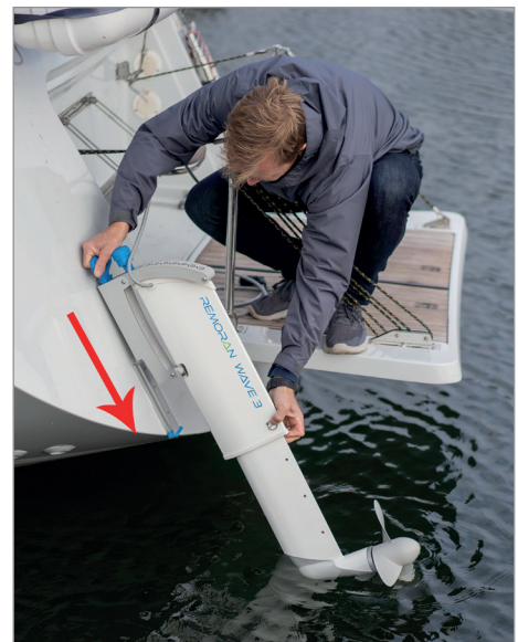
[Kuva 27] Aseta ulkoyksikön runko kiskon yläpäähän ja liu'uta se alas kiskoa pitkin.
